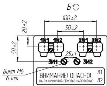
Рис. 2. Контактная площадка ТШЛ-20-1-3. Остальное см. рис. 1
